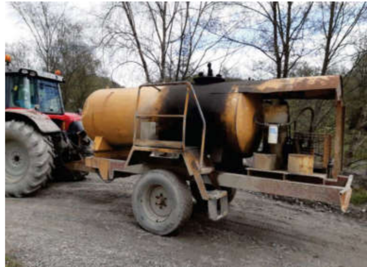
Cuve GNR carrière mobile: 4 m 3 (engins sur chenilles)
